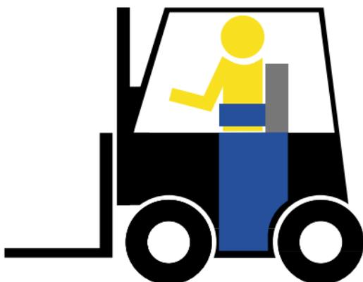
**4** Die Last immer sorgfältig und hinten auf der Gabel aufnehmen! Die Last darf nicht zu schwer sein. Nach der Lastaufnahme wird der Hubmast zum Verfahren nach hinten gekippt.
